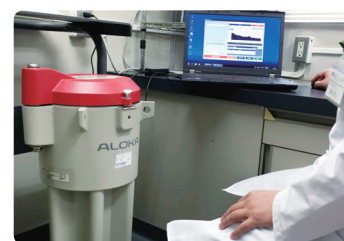
◀スクリーニング検査に 適した 「NaIシンチレーション スペクトロメータ」
