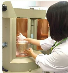
▲ゲルマニウム半導体検出器にセットしている様子
