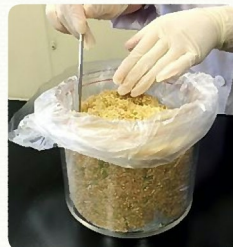
▲玄米をマリネリ容器に充填している様子
