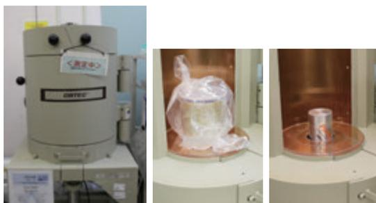
測定機器にセットします。マリネリ容器のくぼみは測定機器のセンサー部分がスッポリと入るようになっています。容器は鉛の部屋に閉じ込められます。鉛は大気中に飛んでいる放射線を遮蔽します。遮蔽することにより検査品中にあるかもしれない放射性物質の正しい値を測定することができます。
