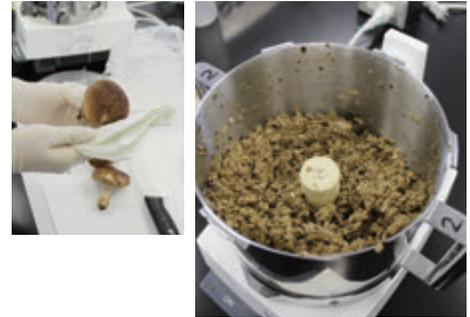
検査品をフードプロセッサーにかけて細かくしていきます。小麦粉やお米などすでに細かい食品、ジュースなどの飲料はそのまま検査をします。食品の分類ごとに放射性物質検査の方法が国の基準で定められています。
