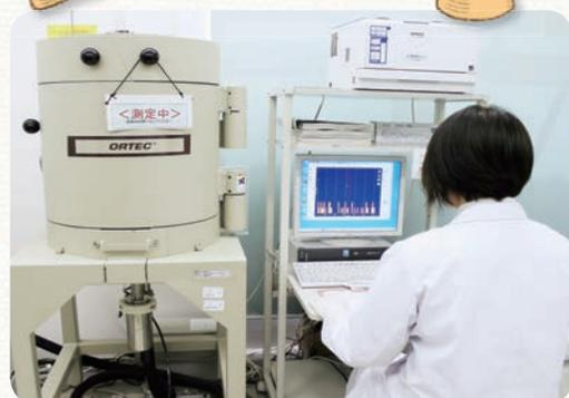
検査精度に優れた「ゲルマニウム半導体検出器」と、スクリーニング検査に適した「NaI シンチレーションスペクトロメータ」の2種類の測定機器を組み合わせ、より多くのサンプルを精確に検査しています。
