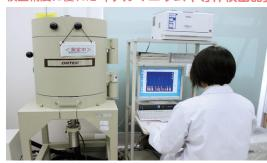
スクリーニング検査に適した 「Nalシンチレーションスペクトロメータ」
