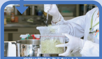
容器に隙間を作らないよう 検体(1検体で約1kg必要)を詰める。
