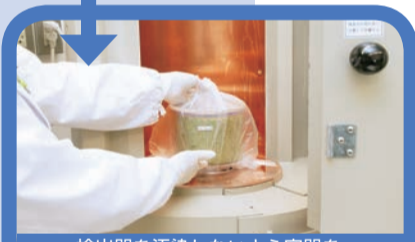
検出器を汚染しないよう容器を ポリ袋へ入れ、検出器へセット。
