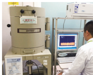
▲検査精度に優れた「ゲルマニウム半導体検出器」
