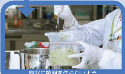
容器に隙間を作らないよう検体(1検体で約1kg必要)を詰める。
