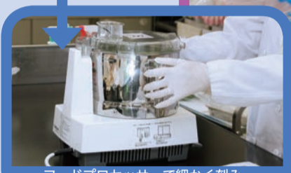
フードプロセッサーで細かく刻み、検体を均質化する。
