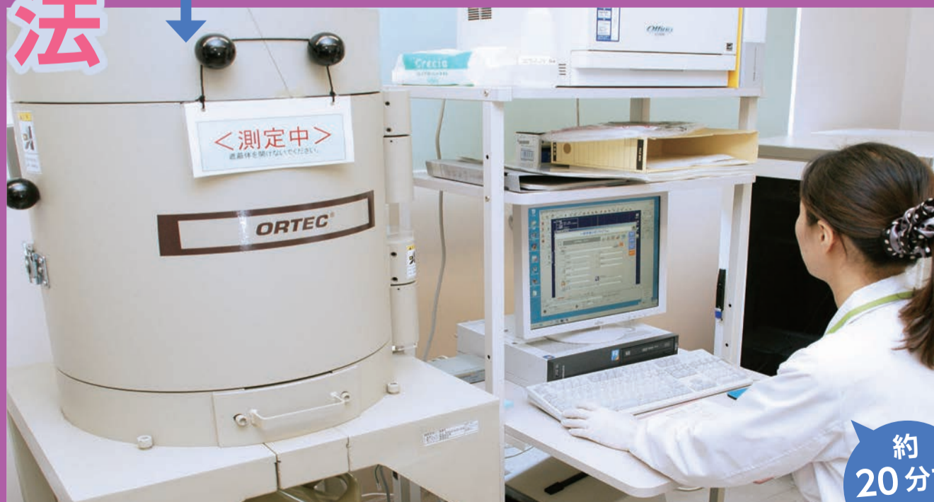
パソコンに検体情報(検体名・産地情報など)と、測定条件(重量、測定時間など)を入力し、測定開始。
