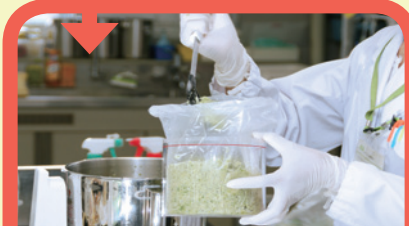
容器に隙間を作らないよう 検体(1検体で約1kg必要)を詰める。
