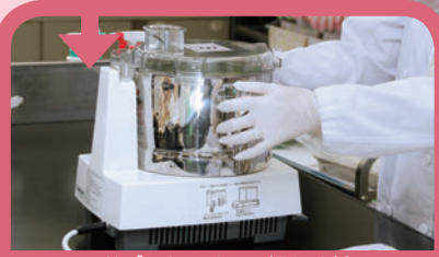
フードプロセッサーで細かく刻み、検体を均質化する。
