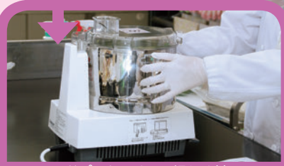
フードプロセッサで細かく刻み、検体を均質化する。
