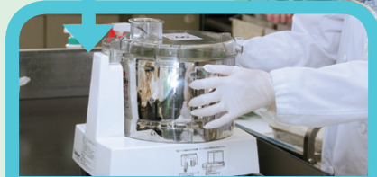
フードプロセッサーで細かく刻み、検体を均質化する。
