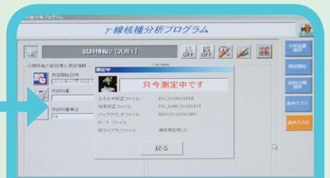
検体から発する放射線を電気信号に変えて、セシウム134、セシウム137の濃度測定をします。
