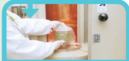
検出器を汚染しないよう容器をポリ袋へ入れ、検出器へセット。
