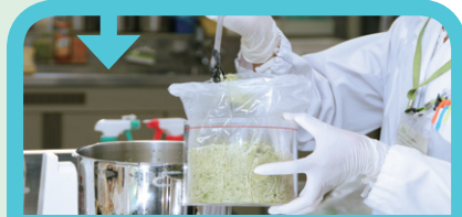
容器に隙間を作らないよう検体(1検体で約1kg必要)を詰める。
