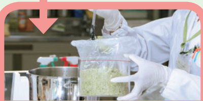
容器に隙間を作らないよう 検体(1検体で約1kg必要)を詰める。
