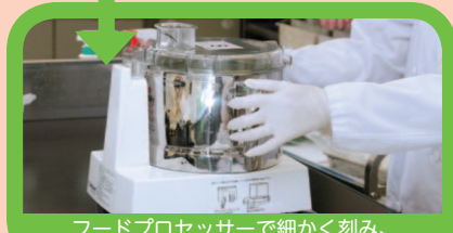
フードプロセッサーで細かく刻み、 検体を均質化する。
