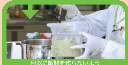
容器に隙間を作らないよう 検体(1検体で約1kg必要)を詰める。
