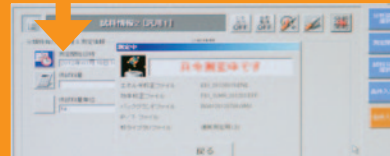
検体から発する放射線を電気信号に変えて、セシウム134、セシウム137の濃度測定をします。
